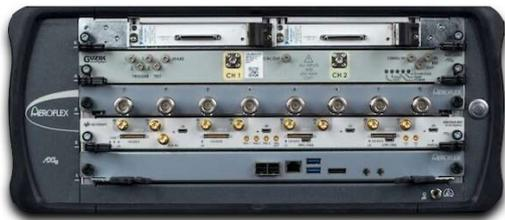
**Рис.5** Объединенная система на основе технологий AXIe+PXIe.
