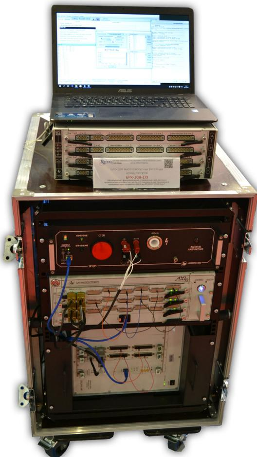
**Рис.7** Пример соединения VXI системы и AXIe системы.
