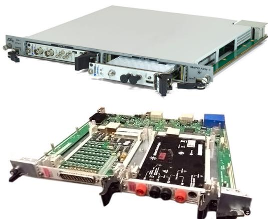
Рис.1 HMPXI AXIE-1 Носитель модулей PXIe и Keysight носитель PXI для AXIe
